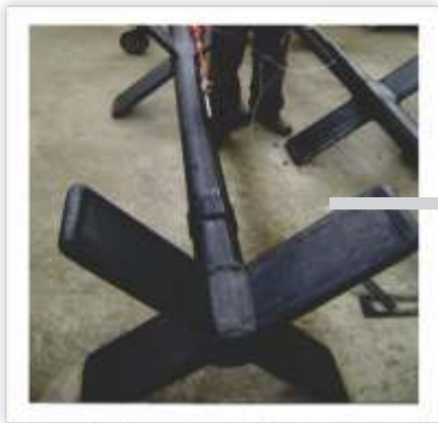
Teste de faíscas em agitador revestido com borracha
