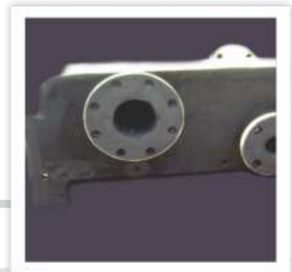
Cabeceira recuperada a caldeiraria, pintada e revestida com ebonite
